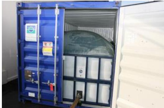
Da un punto di vista operativo ed economico tale soluzione permette di trasformare un container in un container cisterna idoneo al trasporto sia di prodotti alimentari sia di chimici non pericolosi con notevoli vantaggi.
