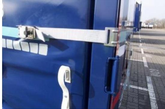
Il detentore è responsabile di effettuare la corretta manutenzione dell'UTI e di sostituire le parti di chiavistellamento danneggiate o usurate del telone scorrevole e del tetto.
