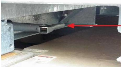
Die Vorrichtungen der Stützbeine müssen korrekt gesichert sein.
