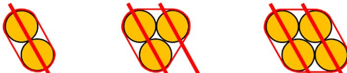
Variante 2: Jede Rolle und jeder Rollenstapel wird durch indirekte Bindung gegen Verschieben gesichert. *Optimale Sicherung!!*
