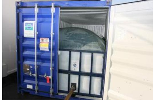
Aus betrieblicher und wirtschaftlicher Sicht ermöglicht diese Lösung die Umwandlung eines Containers in einen Tankcontainer, der sowohl für den Transport von Lebensmitteln als auch von ungefährlichen Chemikalien geeignet ist, was erhebliche Vorteile mit sich bringt.
