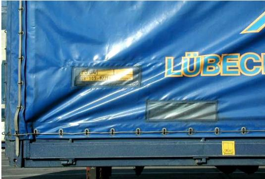
Im Fall von höhenverstellbaren Planenstrukturen mit einer einzigen zugelassenen Höhe für den Bahnverkehr, muss ein eindeutiges Identifizierungssystem (z.B. farbiger Streifen) vorhanden sein.
