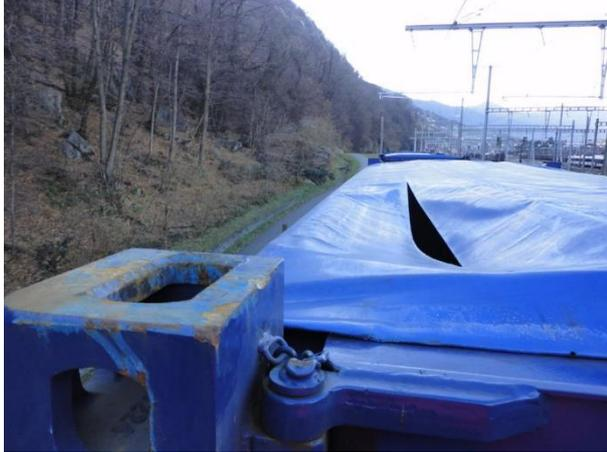
Die Planen müssen in einem sicheren Zustand für den Transport sein, eventuelle Schnitte sowohl oben als auch seitlich müssen verklebt oder verschweisst werden.
