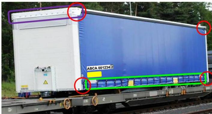
Bauteile, die überprüft werden müssen. Beispiel Sattelanhänger.
