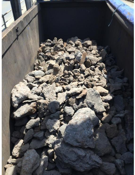
In beiden Fällen löste das schwerere Gewicht auf der linken Seite einen Alarm für Quergewichtsdifferenz seitens eines Gewichtserkennungssystems auf der Bahnstrecke aus.
