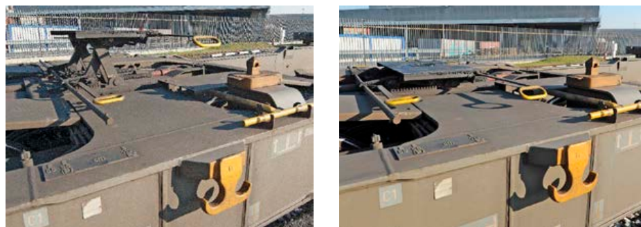
Selletta di appoggio regolabile su tre altezze per il fissaggio dei semirimorchi sui carri tasca di ultima generazione T3000e, nella posizione superiore (a sinistra) e inferiore.
