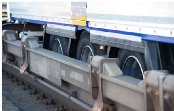
Ore 16.48: Tutto bene: il semirimorchio è saldamente fissato nel carro tasca.
