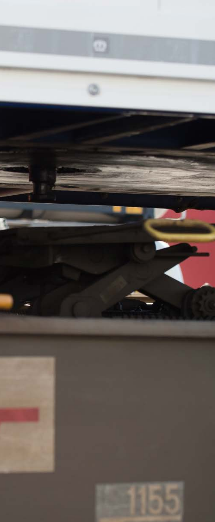
Ore 16.48: Tutto bene: il semirimorchio è saldamente fissato nel carro tasca.
