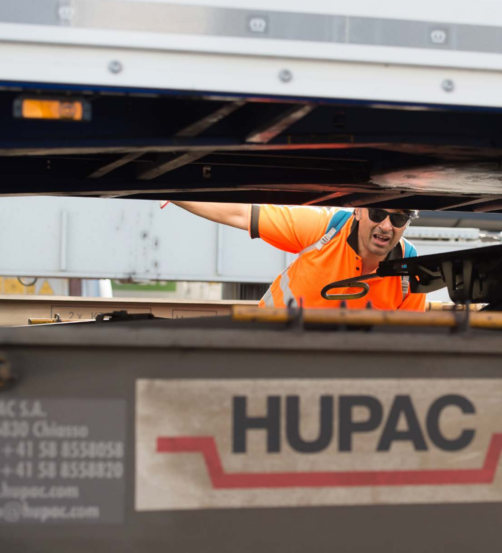
Ore 16.47: L'operatore terminalistico Emanuele Bazzano si accerta che il perno di accoppiamento del semirimorchio vada a innestarsi correttamente nel cavalletto, fornendo al gruista, con la mano e via radio, precise indicazioni di spostamento.
