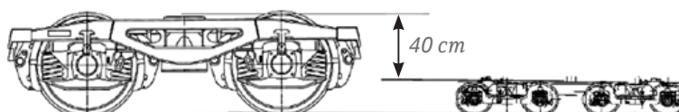
Confronto tra il carrello a 2 assi di un carro pianale o tasca (a sx) e il carrello a 4 assi di un carro RoLa.
