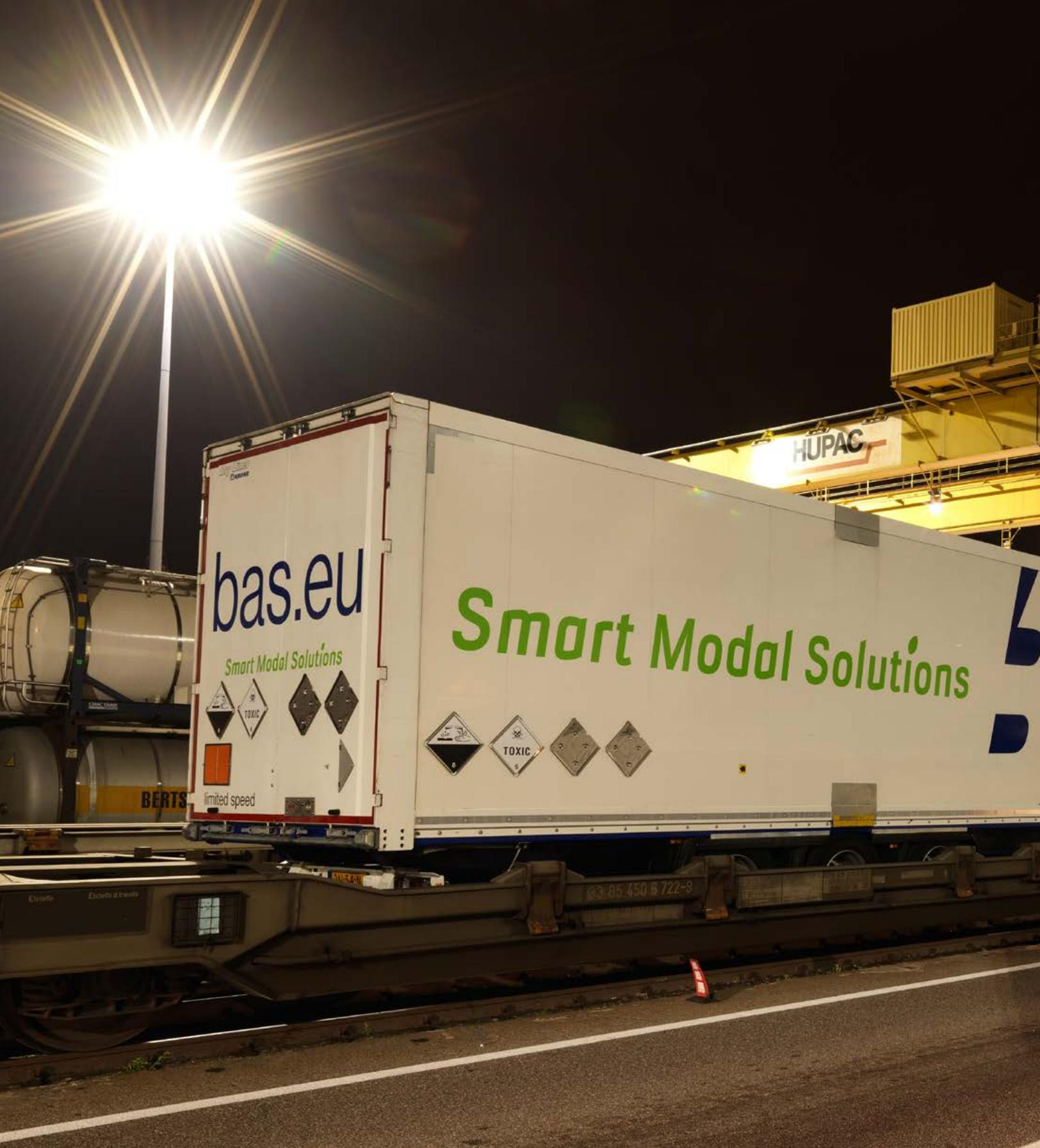
*Donnerstag, 8. September 2016, 2.15 Uhr: Im Verlauf des Mittwoch-Nachmittags ist der Zug beladen worden. Der Wagenmeister hat jeden einzelnen Wagen und jede Ladung noch mal kontrolliert, nun steht der Zug bereit: 24 Bahnwagen, 48 Ladeeinheiten, ohne Lokomotive 521 Meter lang und 1294 Tonnen schwer.*
