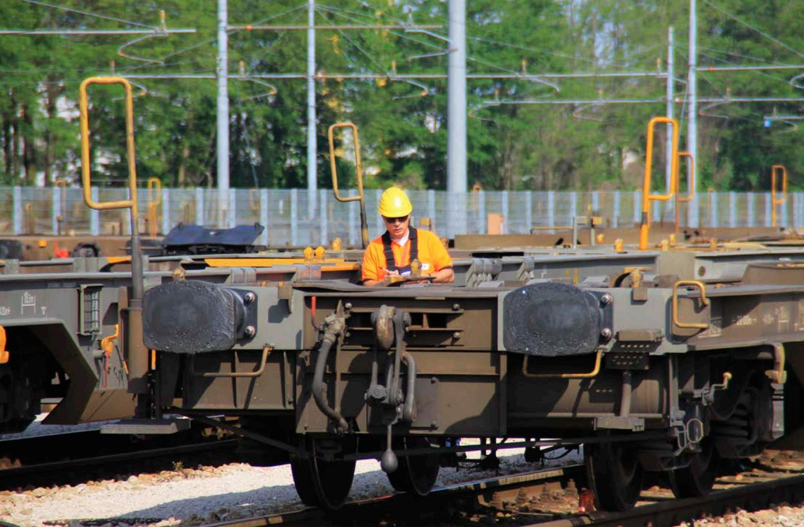
*Wagenuntersuchung im Gleis: Sicherheit bedeutet auch, dass der Zustand jedes einzelnen Wagens permanent überwacht wird, während er im Einsatz steht.*
