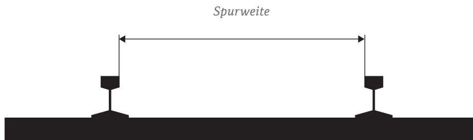
In Russland, Kasachstan, Weissrussland und der Mongolei ist die Spur mit 1520 Millimetern um 85 Millimeter breiter. Ein durchgehender Verkehr aus Europa über Russland nach China ist somit nur schwer möglich. Alle technischen Ausrüstungsvarianten der Wagen für einen automatischen Spurwechsel sind teuer und bedeuten einen Zeitverlust an der Grenze.
