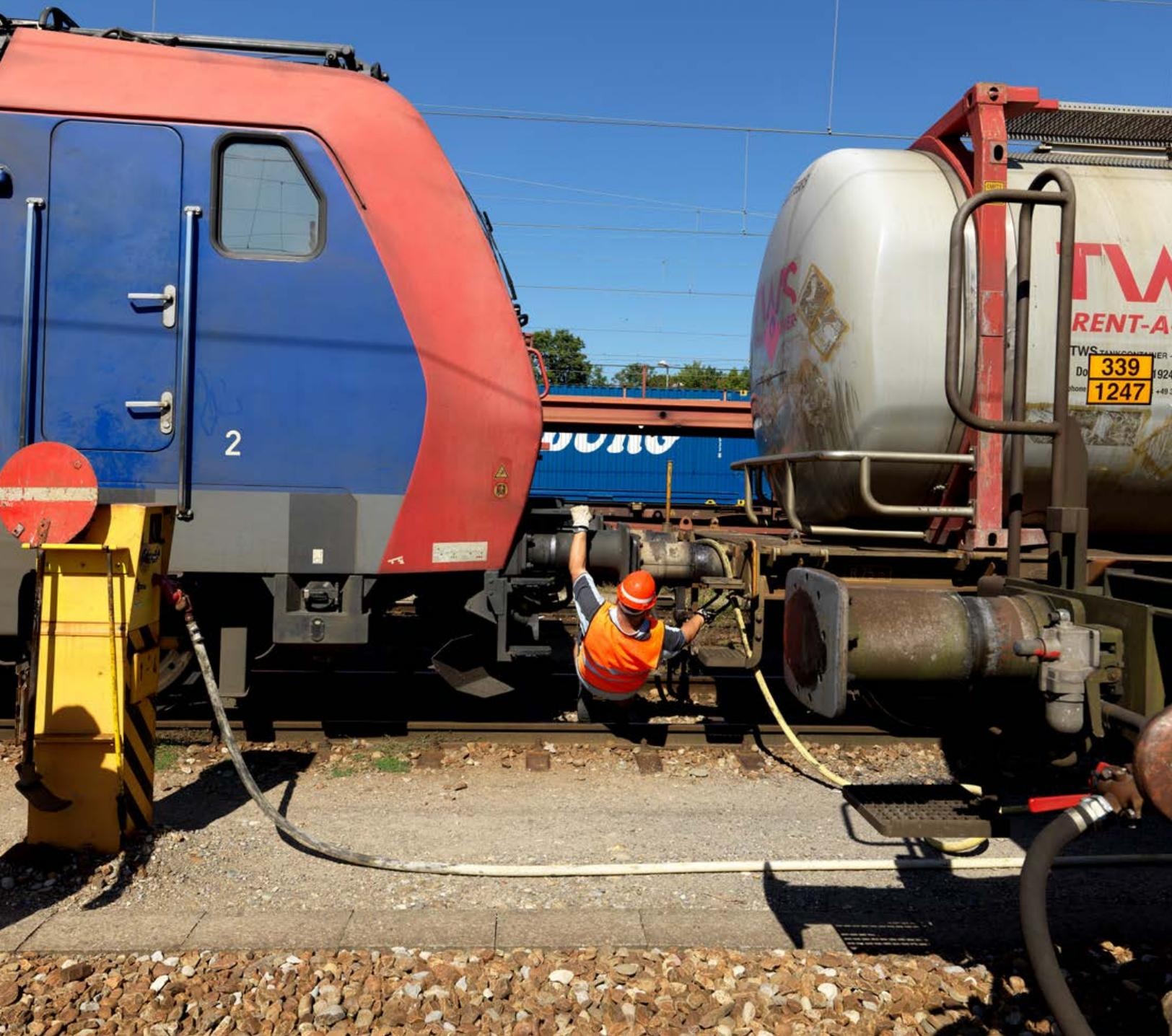
*14.49 Uhr: Lokwechsel. Die Lok Typ 482 ist kürzer und leichter als Typ 47, dafür ist sie als sogenannte Zweisystemlok mit der IT sowohl für das Schweizer als auch für das deutsche Eisenbahnnetz ausgerüstet. Der übernehmende Lokführer Uwe Anders koppelt die Lok gleich selber an den Zug.*
