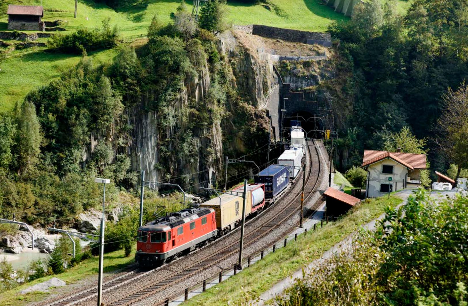
*Die obere Ecke der Ladung definiert die maximale Höhe, mit der ein Zug sicher durch einen Tunnel kommt. Für die modernen Sattelaufleger ist eine Höhe von 4 Metern notwendig.*
