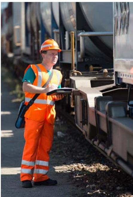
*14.35 Uhr: Roland Dürig, Gefahrgutbeauftragter von SBB Cargo International, kontrolliert mit Hilfe der Wagenliste die mit Gefahrgut beladenen Behälter im Zug. Sein Hauptaugenmerk gilt der vorschriftsgemässen Kennzeichnung gemäss den internationalen Regelungen des Transports von Gefahrgut. Zusätzlich überprüft er, ob die Behälter korrekt verladen wurden und ob allenfalls Beschädigungen erkennbar sind. Bei Zug 40240 gibt es nichts zu beanstanden. Solche Zugkontrollen erfolgen stichprobenweise.*
