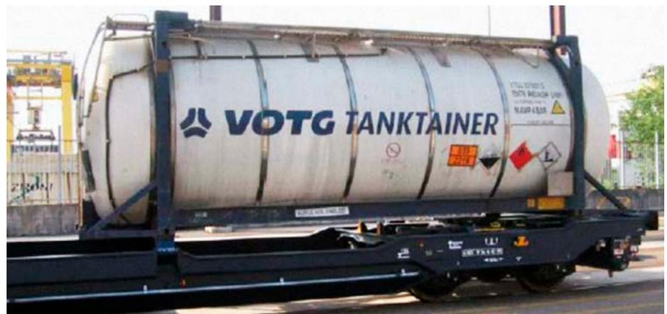
Jeder Taschenwagen ist auch ein Containertragwagen. Durch umklappbare Zapfen können Container über die Ausbuchtung des Taschenwagens gelegt werden. Der Stützbock wird entweder in die Tasche abgeklappt oder in Richtung Wagenende geschoben und verriegelt. Bei der neuesten Generation von Taschenwagen ist die niedrigste Stützbockhöhe tiefer als die Ladehöhe für Container. Deshalb ist es nicht mehr nötig, den Stützbock zu verschieben.
