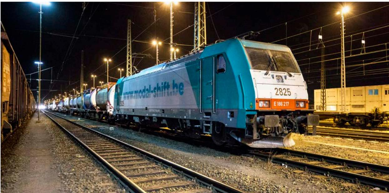
*3.51 Uhr: Ankunft im Güterbahnhof Aachen West. Hier wechseln erneut die Lok, der Lokführer und zum zweiten Mal die Richtung: Die SBB-Lok, die den Zug von Köln bis hierher «verkehrtherum» gezogen hat, wird abgehängt. Am «vorderen» Ende des Zuges dockt eine HLE28 aus der Traxx-Linie von Bombardier an, sie gehört dem belgischen Hupac-Partner B-Logistics. Auch der Lokführer ist ein Belgier. Um 4.48 Uhr fährt der Zug fahrplanmässig weiter ...*
