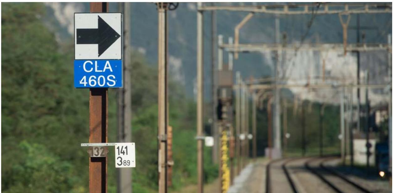
*9.24 Uhr: Kurz nach Bellinzona ist die Strecke mit dem digitalen European Train Control System ETCS ausgerüstet. Die Signalisation ändert entsprechend: Die Schilder geben dem Lokführer keine Instruktionen mehr, sondern weisen ihn lediglich darauf hin, dass hier ein digitaler Sendepunkt ist. Die jeweiligen Impulse kann Franco Menghetti auf seinen Computern im Lokführerstand ablesen.*
