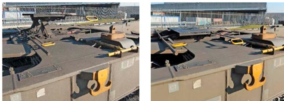
*Dreifach höhenverstellbarer Stützbock für die Verankerung von Sattelaufliegern im Taschenwagen der neuesten Generation T3000e in höchster (links) und tiefster Position.*
