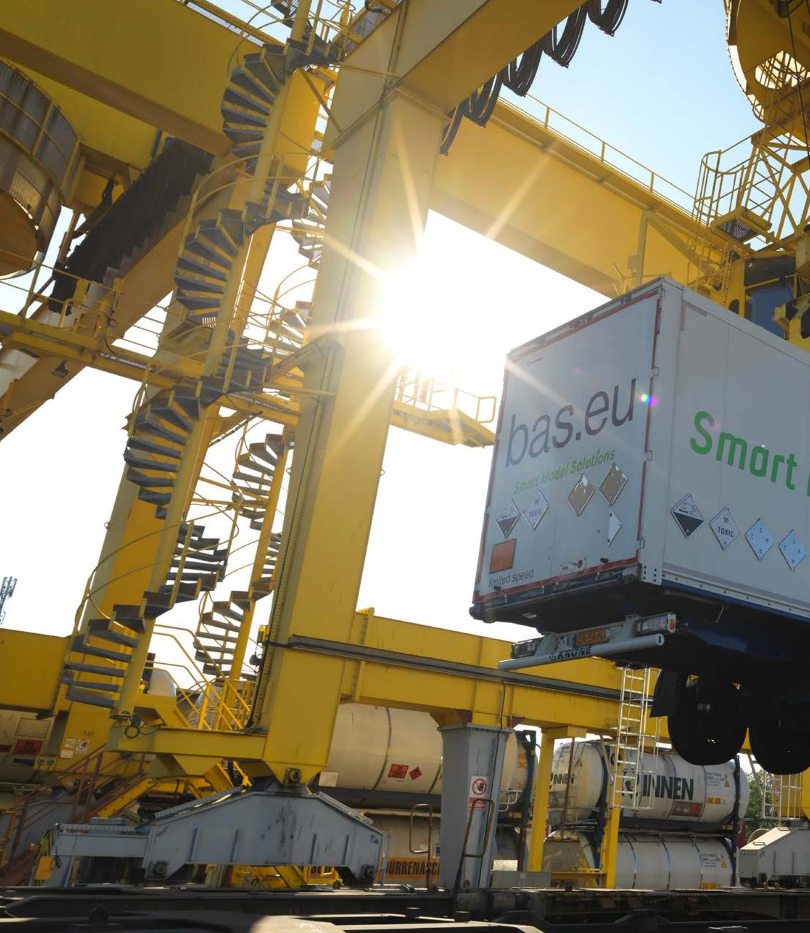
*16.46 Uhr: ... schwebt der Sattelaufleger über dem Bahnwagen, einem Taschenwagen mit dreifach höhenverstellbarem Stützbock.*
