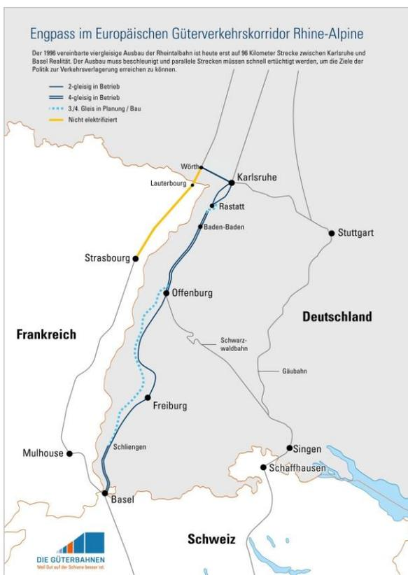
L'aménagement de la ligne de la vallée du Rhin, convenu par contrat et partie intégrante du concept NLFA, avance lentement. La mise à niveau vers un trafic à quatre voies, une longueur de train de 740 mètres et un poids de train de 2000 tonnes permettra d'augmenter de manière significative la capacité et la performance de la ligne.
